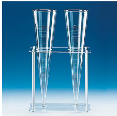
圖 2. 因何夫錐(Imhoff cone)常被用來衡量可沈澱固體、總懸浮固體、甚至浮游動物如涵蟲、橈足蟲、劍蚤等的濃度或密度(mL/L)。
